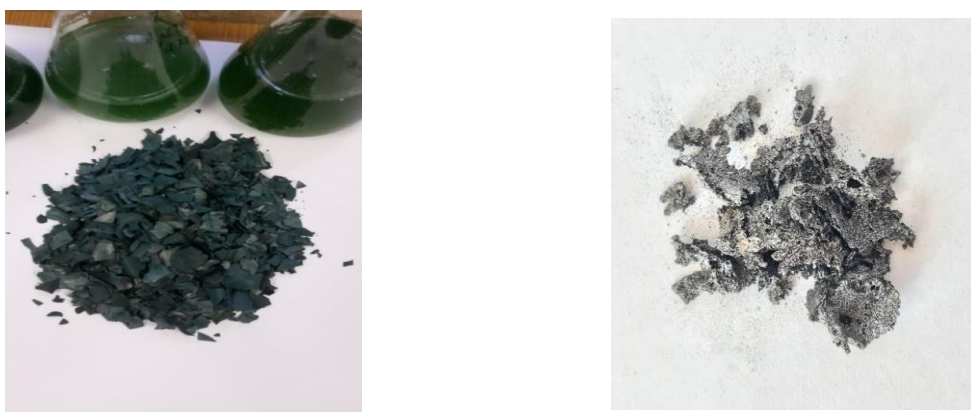
Рис. 1. Исходная биомасса МКВ (слева) и биоуголь после пиролиза (справа)
